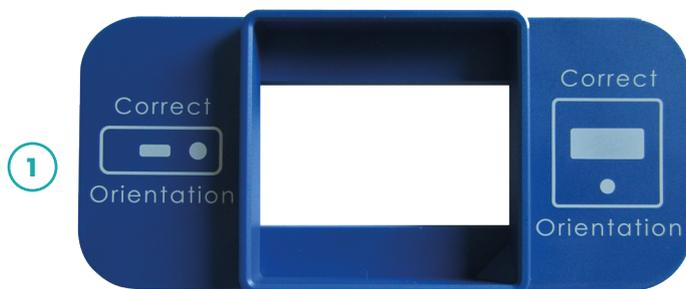
1. Compruebe «la orientación correcta» indicada en el adaptador para el aparato de prueba y el aparato RapiRead™ CUBE
